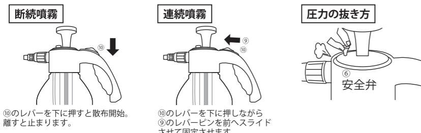
※一定以上加圧すると安全弁⑥から自動的に圧力が放出されます。
